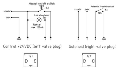
Picture 35: HMG PRO Control wiring
